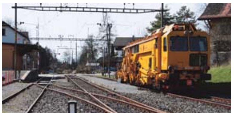
Modernste Stopfmaschine wartet auf den nächsten Einsatz.
