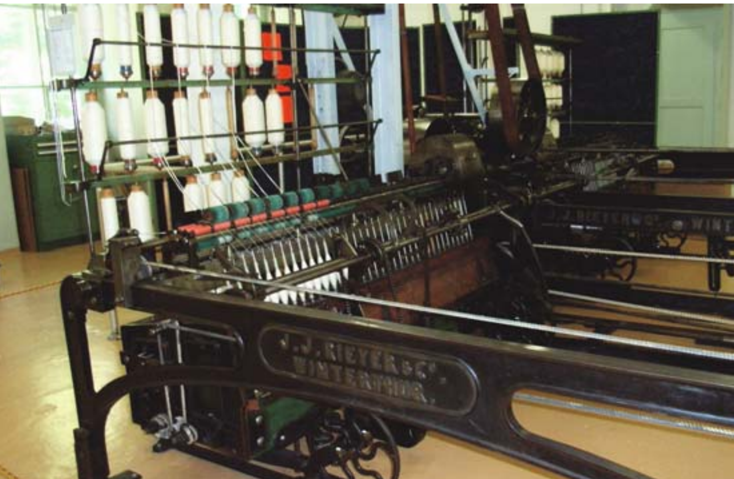
Wagen-Spinnmaschine, auch Selfaktor genannt. Gebaut 1889 bei der Firma J. J. Rieter, Winterthur.
