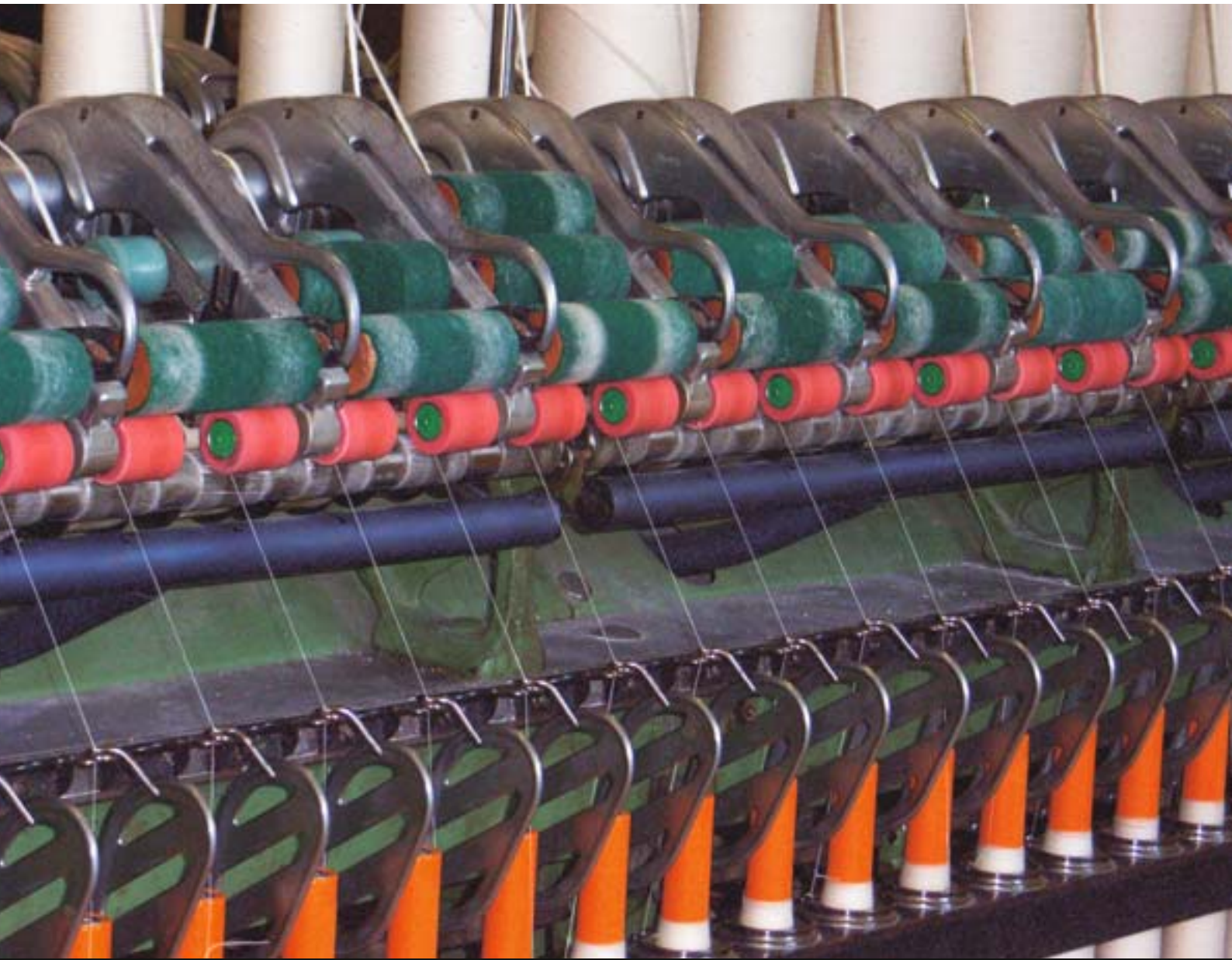
Ringspinnmaschine, erbaut in der ersten Hälfte des letzten Jahrhunderts.
