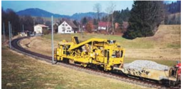
Die Schotterplanier- und Pflugmaschine der J. Müller AG im Einsatz.
