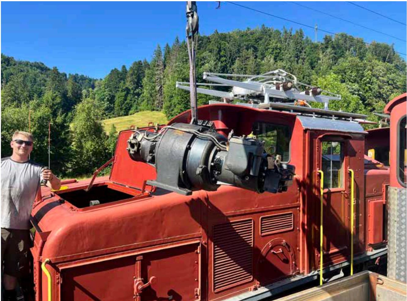
Der revidierte Kompressor wird an der Ee 3/3 eingebaut
