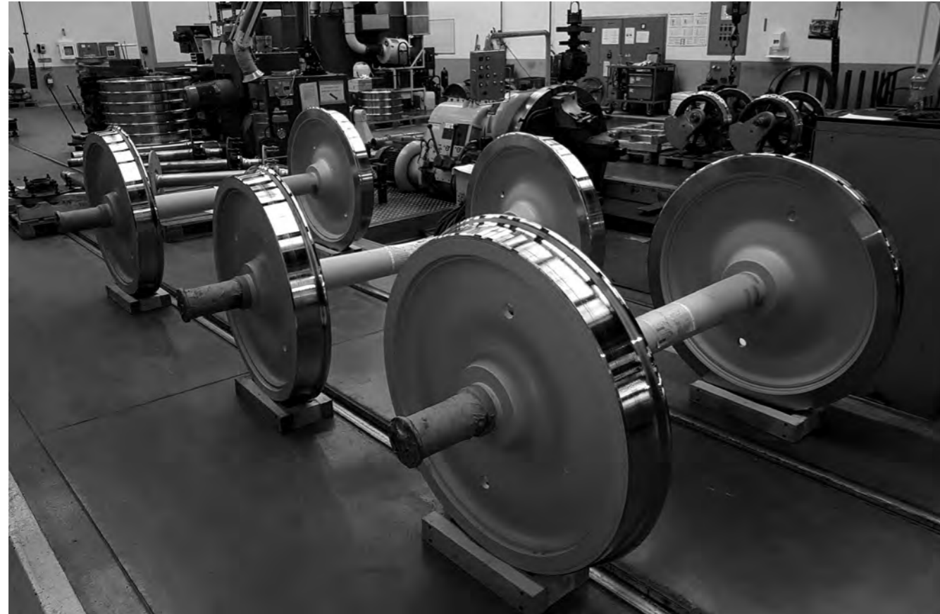
In neuem Glanz: Die geprüften und reprofilierten Radsätze
