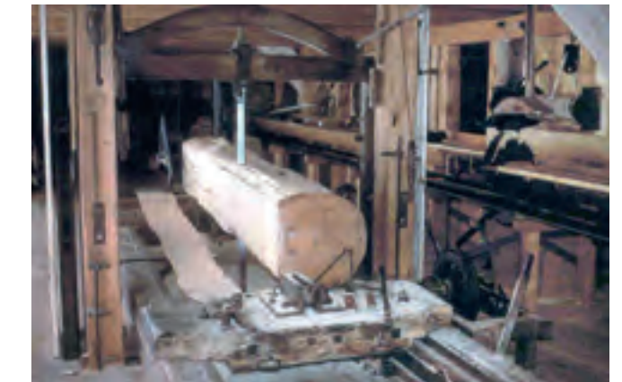
Einfachgattersäge getrieben mit Wasserrad
