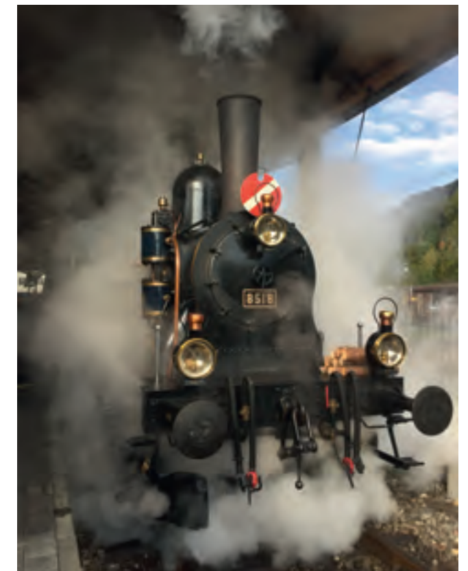
Vorheizen der Zylinder vor der Abfahrt: Mehr als nur eine Show für die Fahrgäste
