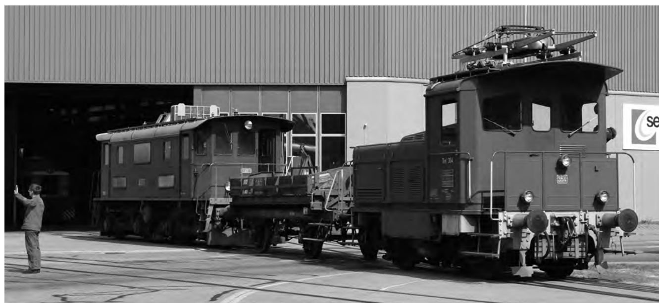
In der Halle der Firma sersa in Hinwil darf der DVZO die Einrichtungen verwenden um den 8 t schweren Trafo aus der Be4/4 heraus zu heben und revidiert wieder an seinen Platz zu hieven.
