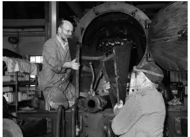
Montage des engmaschigeren Funkenfängers
