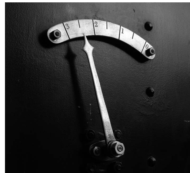
Wasserstand-Anzeige der Lok SCHWYZ
