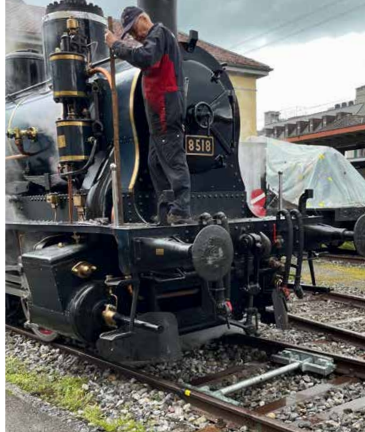
Dampflok E 3/3 Nr. 8518 beim Einstellen der Rad-Aufstandskräfte 29.04.2023
