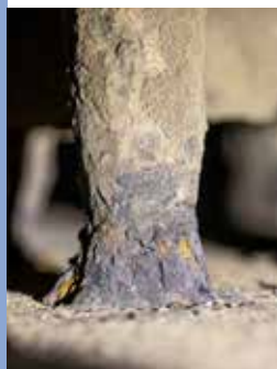
Deckenanker mit den typischen Einschnürungen
