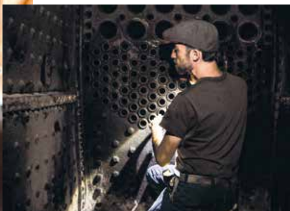
Regelmässige Kontrollen der Kupferfeuerbüchse und der Siederohre. Safety first!
