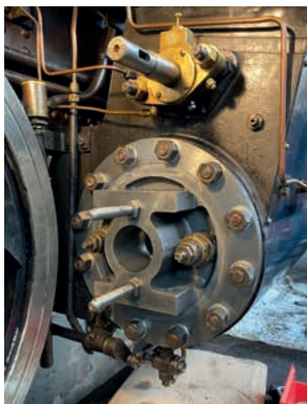
Neuanfertigung eines gusseisernen Dampflok-Zylinderdeckels. Vom CAD Modell...
