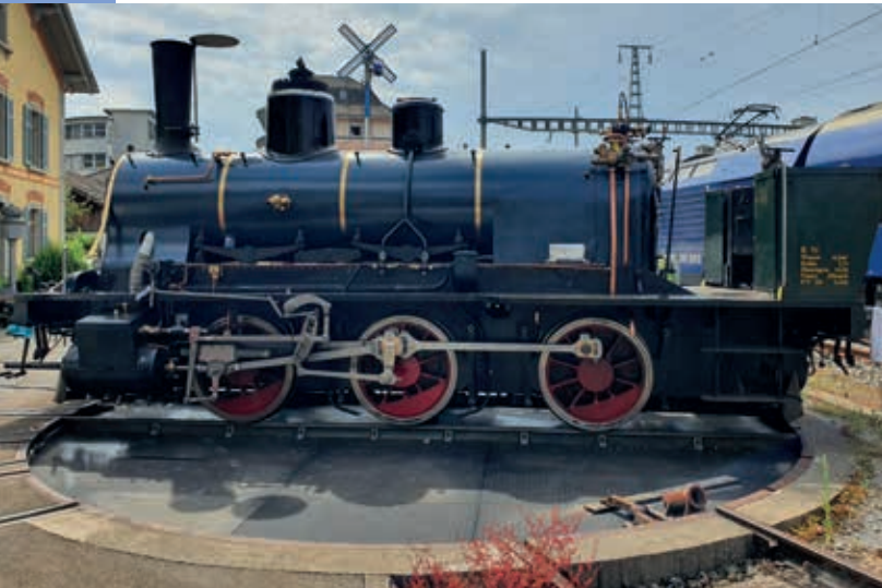
Lok 8518 drehen um Führerhaus aufzusetzen
