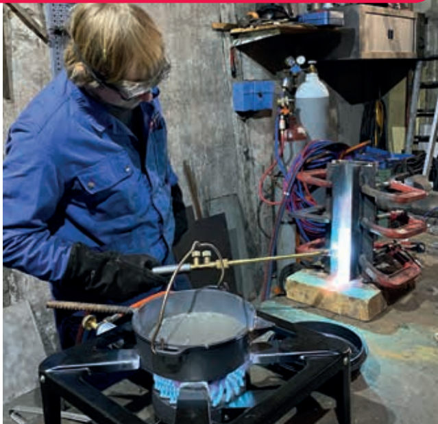
Ausgiessen der Gleitlager mit Weissmetall. Ein historisches Handwerk
