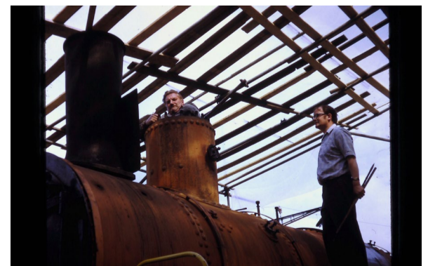
Einstieg durch den engen Dampfdom
