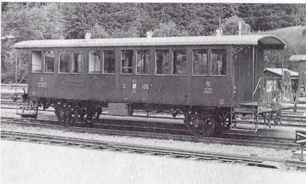
C2 Nr. 105-8/4* ex SZU Baujahr 1898-99 Plätze 56 Länge über Puffer 11700 mm Gewicht leer 11 t
