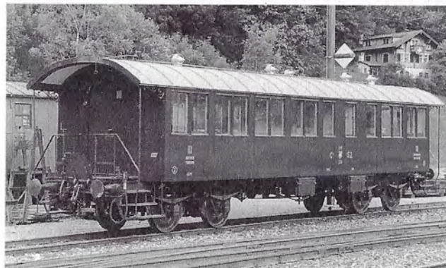
BC4 Nr. 151* ex STB Baujahr 1894 Plätze 70 Länge über Puffer 14900 mm Gewicht leer 18 t
