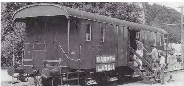
F3 Nr. 252 Leihgabe SBB DVZO-Verkaufswagen Baujahr 1908 Länge über Puffer 14 040 mm Gewicht leer 19,3 t
