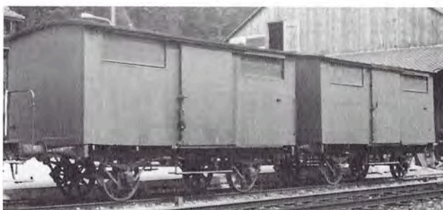
K2 Nr. 301* ex TTB 302* ex TTB 304* ex TTB Materialwagen Baujahr 1875 Länge über Puffer 7 000 mm Gewicht leer 7,2 t
