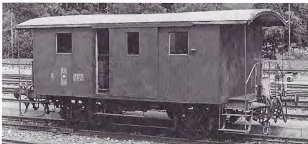
F2 Nr. 201* ex JS Baujahr 1892 Länge über Puffer 10 000 mm Gewicht leer 13 t
