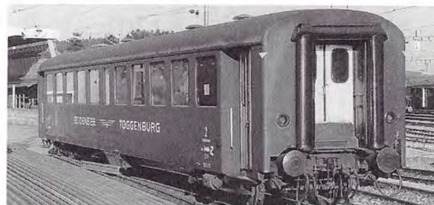
X4 Nr. 161 ex BT DVZO-Mannschaftswagen Baujahr 1951 Länge über Puffer 21 460 mm Gewicht 26 t Höchstgeschwindigkeit 125 km/h
