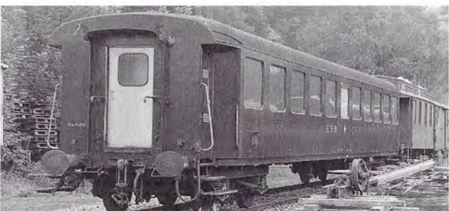
X4 Nr. 160 ex SBB Kleidermagazin Baujahr ca. 1935 Länge über Puffer 21 400 mm Gewicht Tara 31 t
