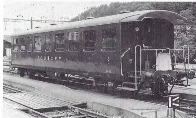
BC4 Nr. 153/5 ex SBB Baujahr 1950 Plätze 56 Länge über Puffer 18400 mm Gewicht leer 20 t
