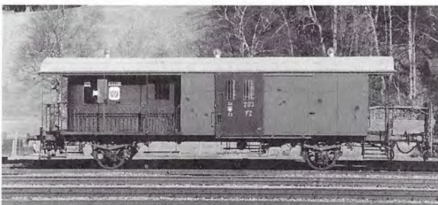
FZ2 Nr. 203 Baujahr 1911 Länge über Puffer 11 600 mm Gewicht leer 14,9 t
