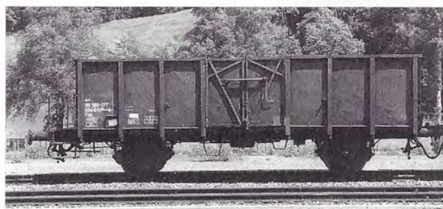
E 354 und 355 ex SBB Kohlenlager Baujahr 1940 Länge über Puffer 9 830 mm Gewicht 10,5 t
